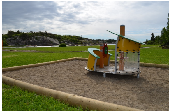
Eksempel på fallunderlag ved to av kommunens lekeplasser; gummimatte brukt i Domkirkeparken, støtsand på Mærrapanna.
